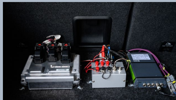
Das DME-Einspritzsystem wird von einem Steuergerät im Kofferraum geregelt. Motor- und Einspritzsteuerung kommunizieren über eine spezifische CAN-Schnittstelle miteinander.
