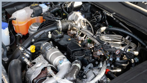
Der 1,5-l-Dieselmotor musste für die DME-Einspritzkomponenten angepasst werden.
