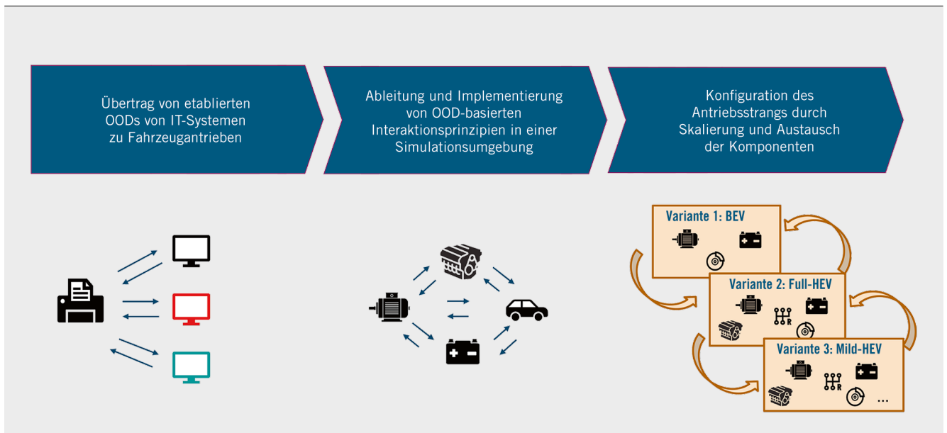
BILD 1 Konzept des Übertrags von OOD-Prinzipien auf die Entwicklung hybrider Antriebssysteme (© TUD)
