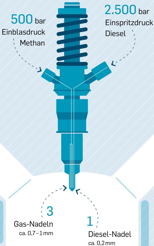
→ Das Methan wird unter hohem Druck direkt in den Brennraum eingeblasen und nicht vorgemischt – dies ermöglicht tiefere Methanemissionen im Vergleich zu vorgemischten Brennverfahren.
